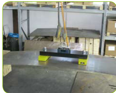
FXE-T zur Aufnahme von dünnen Blechen
