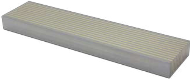
Lamellenauflegeplatten in Längspolteilung, silberhartverlötet in Polteilung 3+1mm
