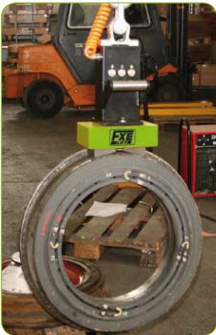
FXE mit Formpolschuh für Eisenbahnräder
